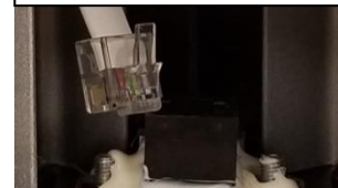
Câble de cellule de pesage non connecté
