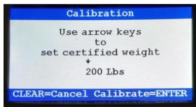
8. La pantalla le pedirá colocar las pesas de calibración en la plataforma. Presione **Enter** cuando las pesas de calibración estén sobre la plataforma.
