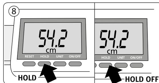
Para fijar la estatura sobre la pantalla, presione **HOLD**. Para liberar la estatura, presione **HOLD** nuevamente.
