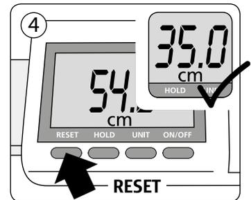
Presione **RESET** para fijar la referencia de estatura a 35 cm.\*Este paso debe realizarse cada vez que se encienda el tallímetro.
