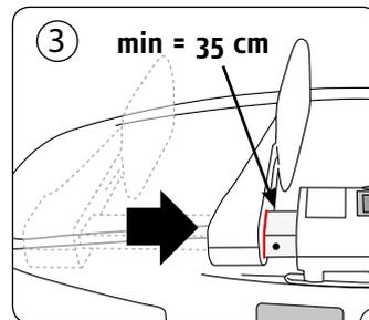
Deslice el panel de medición completamente hacia dentro en dirección a la pantalla digital.
