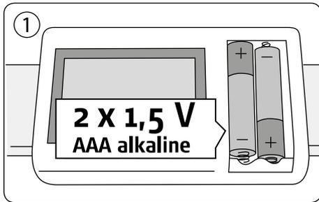
Deslice y abra el compartimiento de las baterías a un lado de la pantalla digital. Inserte 2 baterías AAA y vuelva a colocar la cubierta del compartimiento.
