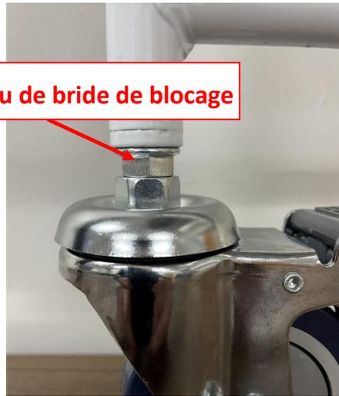
5. Remplacez la balance en position verticale. Assurez-vous que les quatre roues sont en contact avec le sol. Si nécessaire, ajustez seulement la roue qui ne touche pas le sol.
