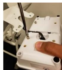
8. Alignez l'afficheur avec le support de montage situé sur la barre d'appui. Fixez l'afficheur au support de montage en insérant les deux vis retirées à l'étape précédente à travers le support et dans l'afficheur.
