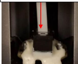
Cable de celda de carga
