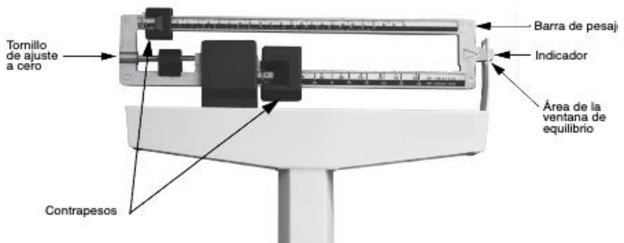
Figura 4-1. Ubicación de la Ventana de equilibrio y el tornillo de ajuste a cero (se muestra la version de lb y kg)
